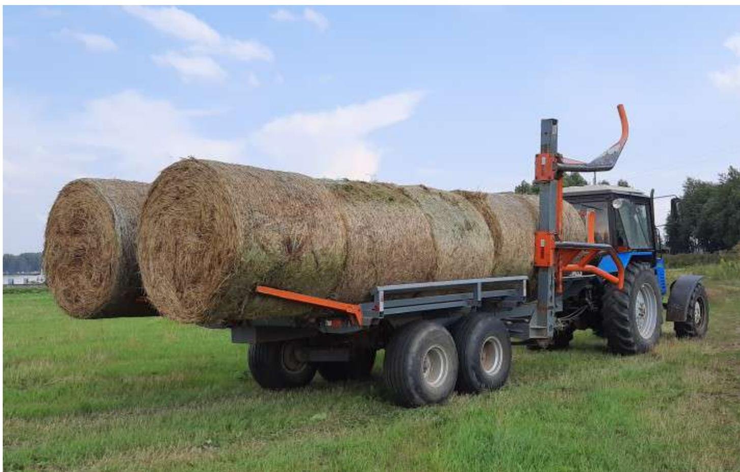
Подборщик-транспортировщик рулонов TRB заменяет ТРИ различных агрегата. Предназначен для подбора рулонов корма (сенажа или сена) в поле, их транспортировки к месту хранения и разгрузки. Весь процесс выполняется одним механизатором.
