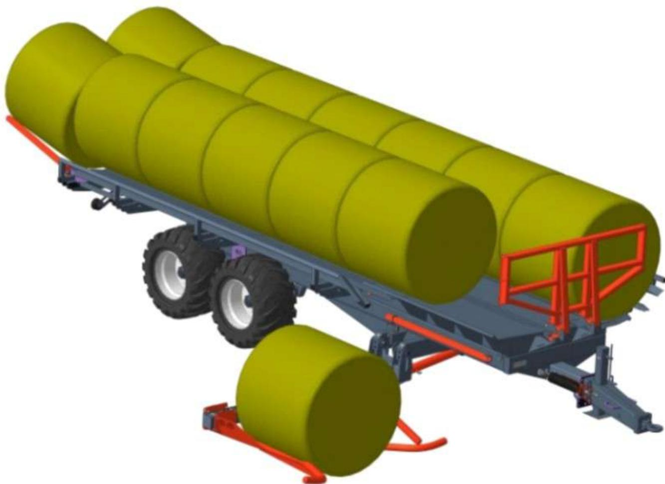
Подборщик-транспортировщик рулонов TRB заменяет ТРИ различных агрегата. Предназначен для подбора рулонов корма (сенажа или сена) в поле, их транспортировки к месту хранения и разгрузки. Весь процесс выполняется одним механизатором.
