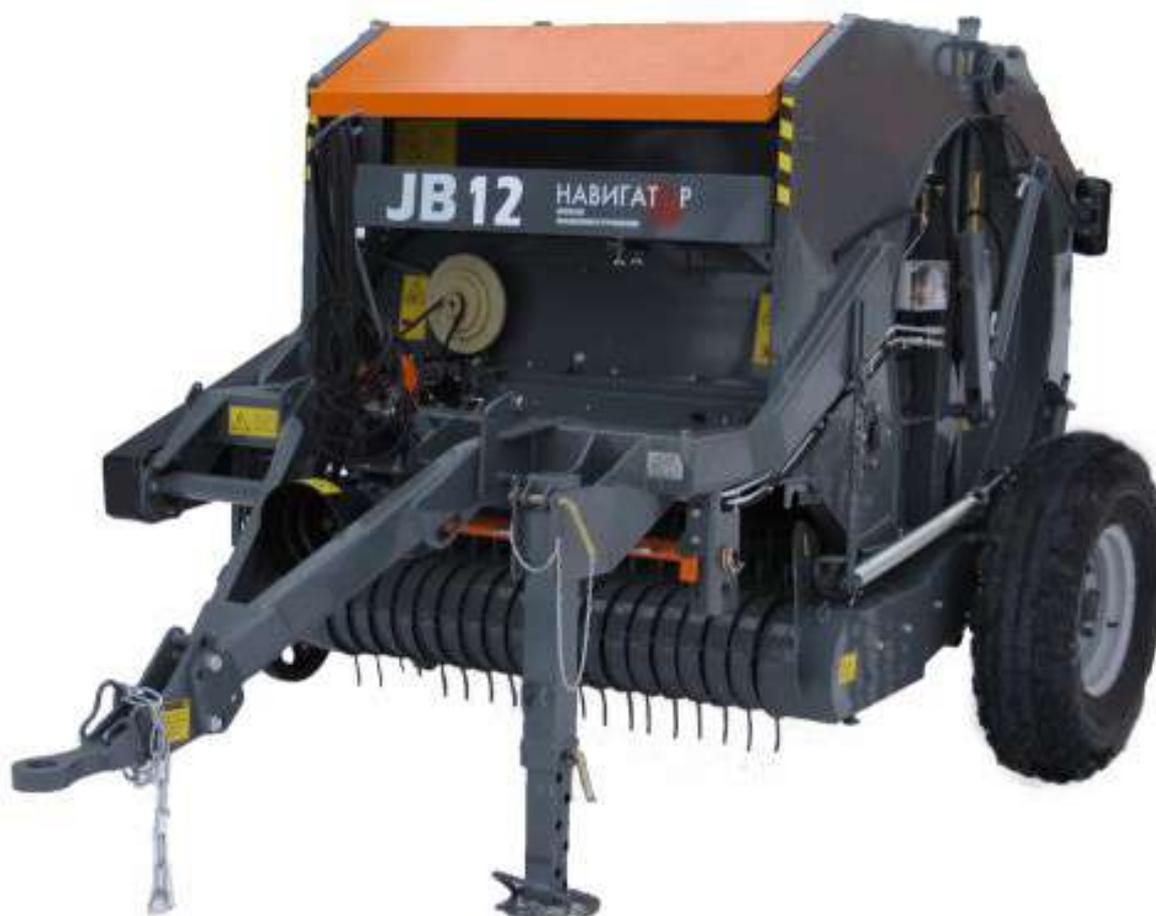
Пресс-подборщик JB12 и JB12NW Предназначен для подбора травяной массы из валков или прокосов в рулоны цилиндрической формы с высокой плотностью прессования. .
