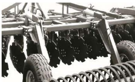
Гидравлическая система обеспечивает параллельный подъем бороны.
