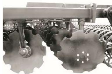
Рабочие органы сферические диски с вырезами Ø 560 мм на индивидуальной стойке из борсодержащей стали.
