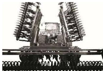
Гидрофицированная складная борона упрощает транспортировку бороны и обеспечивает копирование рельефа.
