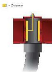
Усиленная стойка (Ф58мм) режущего узла с точкой смазки, предотвращающей закоксовывание сопряжения стойка-втулка рамы.
