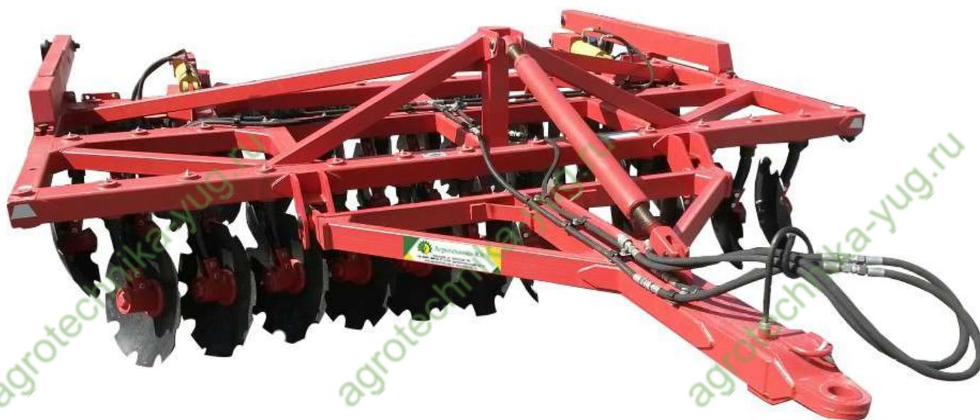
Борона дисковая модернизированная серии БДМ предназначена для уничтожения сорной растительности и измельчения пожнивных остатков, для предпосевной обработки почвы с одновременным дроблением комьев и прикатыванием поверхностного слоя почвы. Борона предназначена для использования во всех почвенно-климатических зонах, кроме зоны горного земледелия. Рабочими органами бороны являются сферические диски, индивидуально установленные на поворотных стойках
