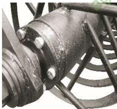
Резиновый компенсатор на оси шлейф катка защищает подшипник от перегрузок.
