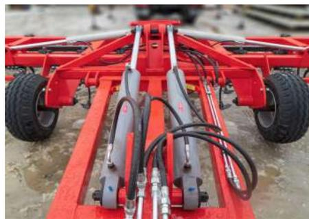
Регулировка глубины обработки почвы дискретная (пошаговая), происходит в пределах от 4 до 12 см (с учетом «проседания» опорных колес до 5 см), производится путем перемещения полуосей по сектору с шагом регулировки ~1 см.
