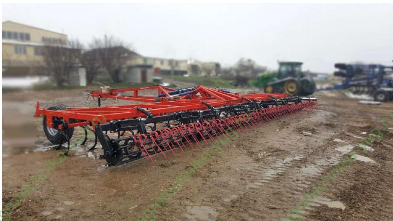
Сзади могут устанавливаться два вида катков  $\varnothing 410$  мм: планчатый или трубчатый (цельнолитой кругляк диаметром 30 мм) каток. Шлейф-катки оснащены амортизационной регулировочной системой, которая нивелирует ударные нагрузки от работы катка, позволяет регулировать глубину обработки почвы. Обеспечивают дробление, выравнивание и мульчирование верхнего слоя почвы по всей ширине захвата орудия.
