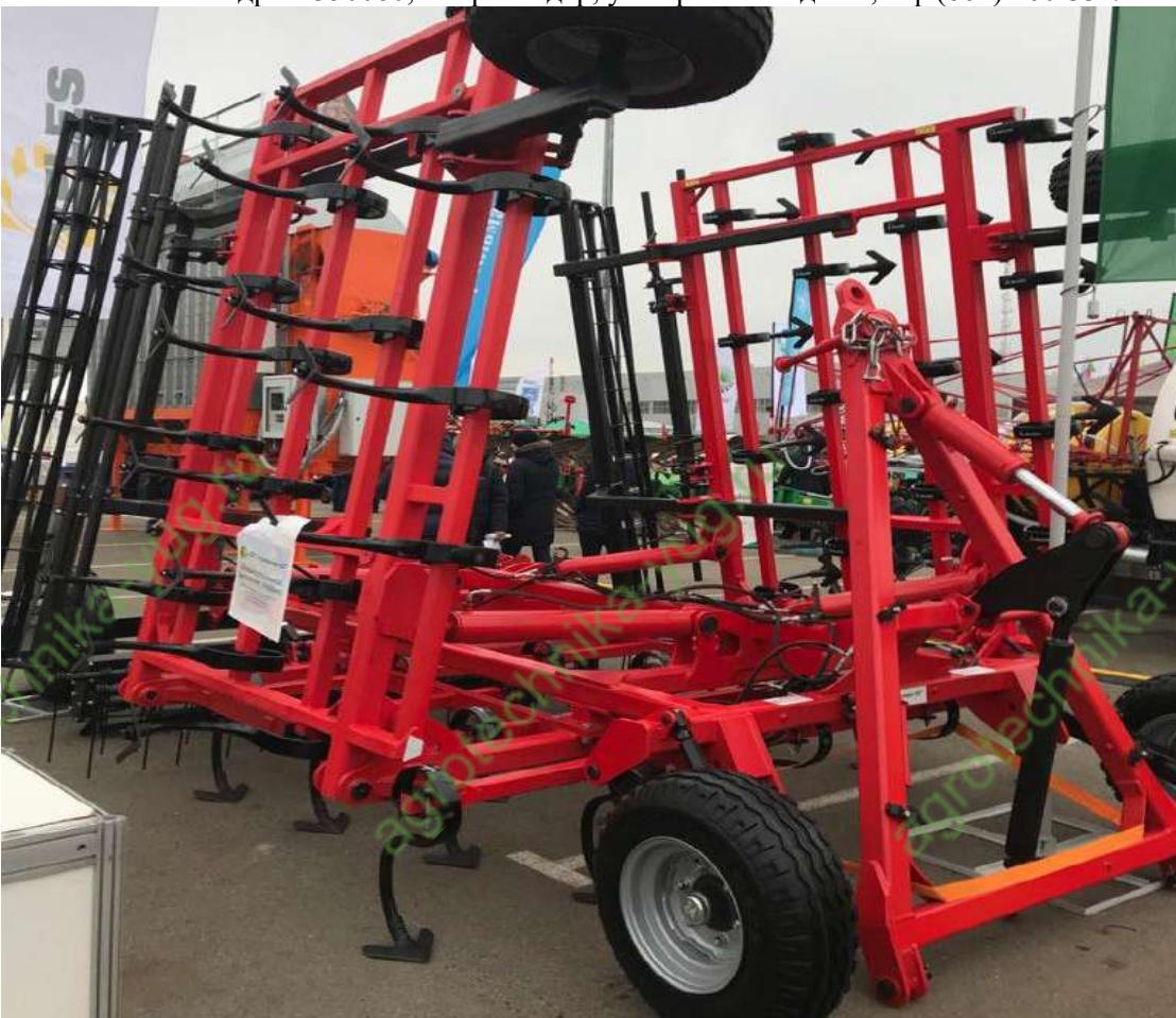
**Надежная конструкция гидравлики позволяет складывать и раскладывать культиватор для работы в поле и транспортировке.**
