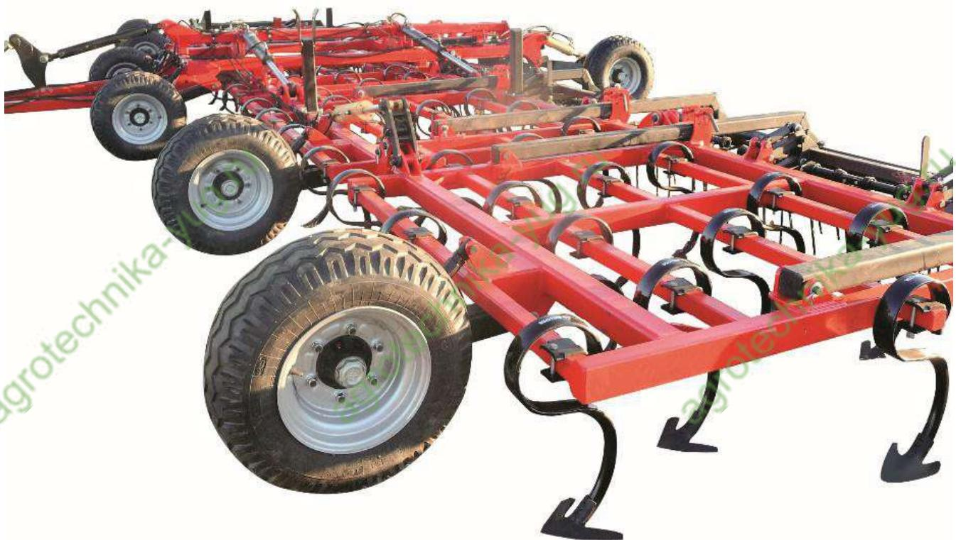
Культиваторы КС сплошной обработки предназначены для поверхностной обработки почвы на глубину до 12см, выравнивания и рыхления почвы, уничтожения сорняков.
