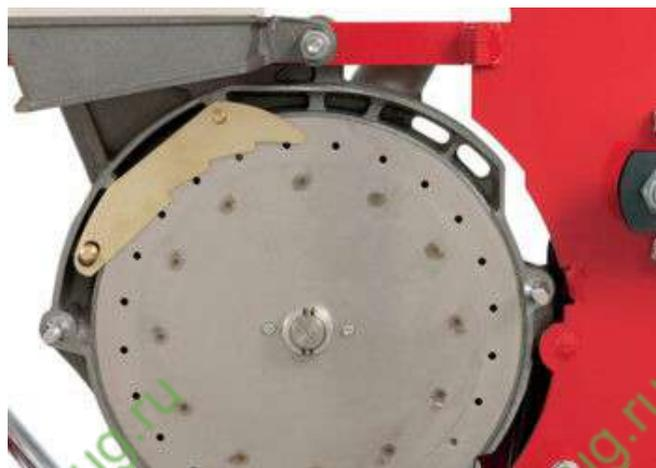
Прочный и легкозаменяемый высеваящий диск из стали inox плотностью 1,2 mm
