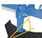
Регулируемый рабочий орган. Изменение угла входления (атаки) при работе на твердых почвах;
